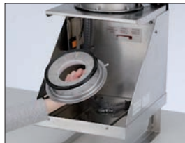
Insats första avvattning
