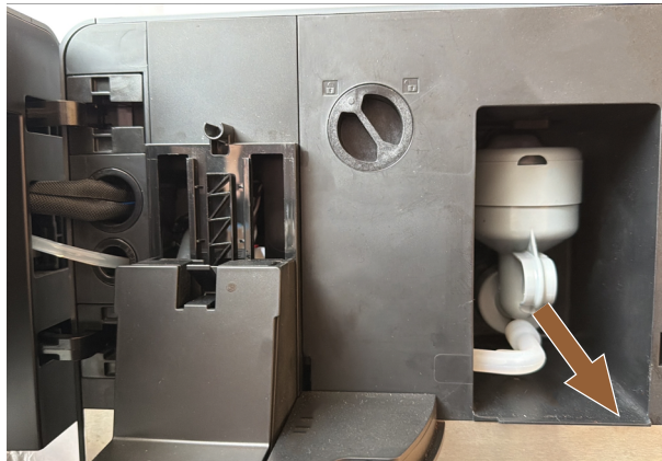
图 124: 将搅拌器向前拉
