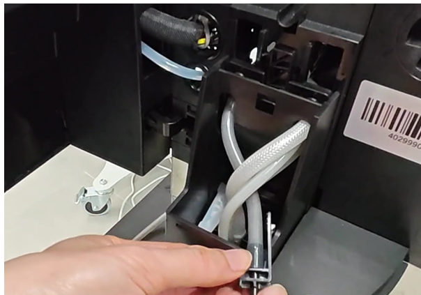
图 119: 将牛奶管从支架中拉出
