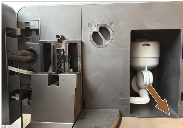
图 88: 将搅拌器向前拉
