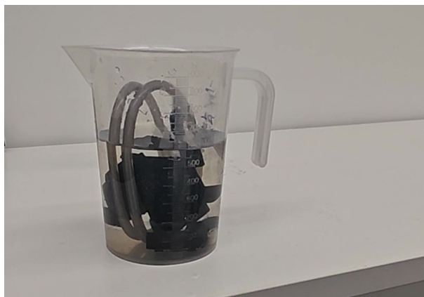
図 122: すべてのミルクが通る部品を洗浄液に漬けます
