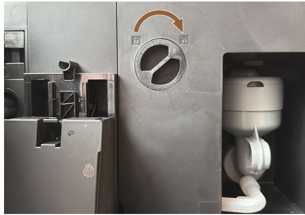
図 129: 回転ノブを回してロック解除します
