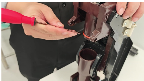
図 185: 抽出器ガスケットの交換
