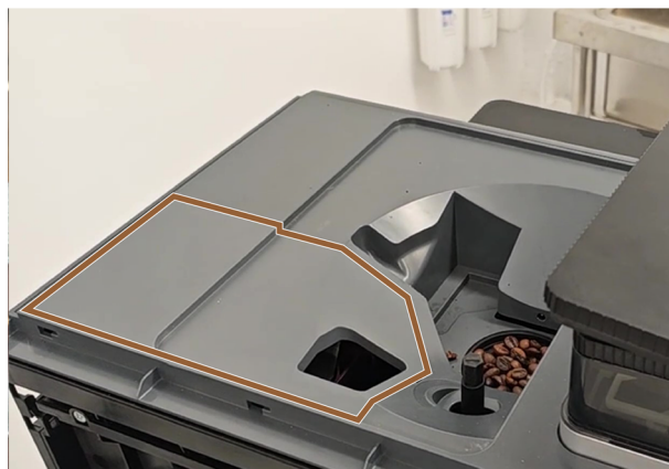
図 108: 背面パネルを取り外します
