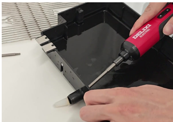
Рис. 16: Извлечение силиконовой заглушки
