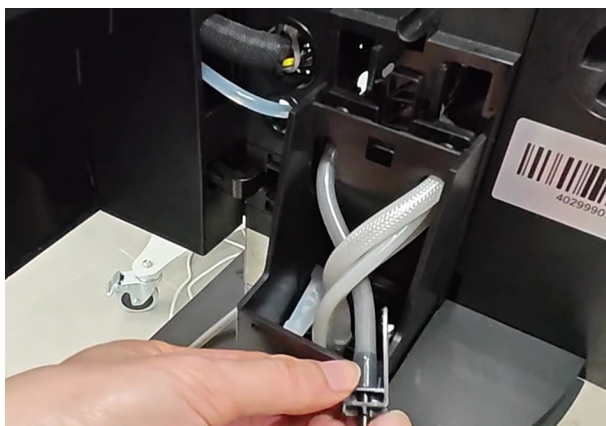
Рис. 119: Извлечение молочного шланга из держателя
