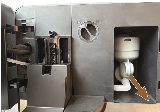
Рис. 124: Вытягивание миксера вперед
