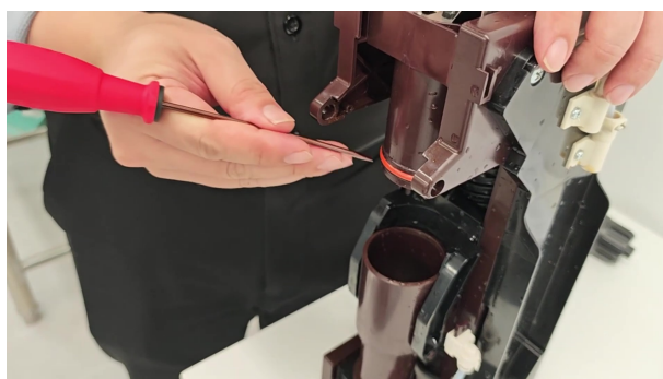
Рис. 185: Замена прокладки узла приготовления
